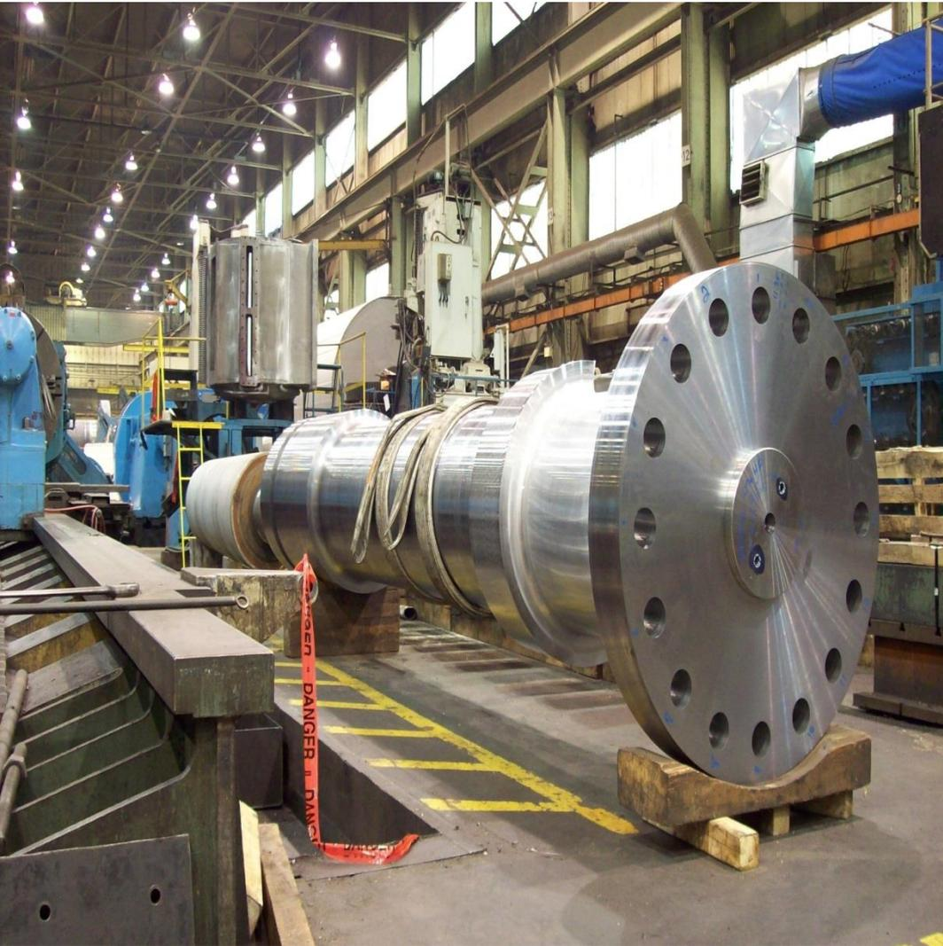
Albero di trasmissione di turbina idroelettrica: immagine tratta da fab3r.com
